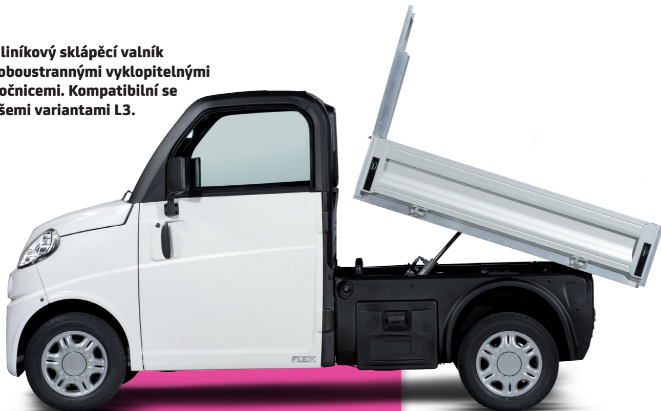
Flex L3 sklápěcí valník s hydraulickým válcem (Model vybavený Comfort Packem)
